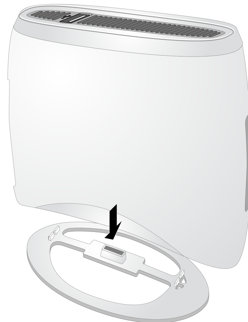
Figura 5 Instalação na base
